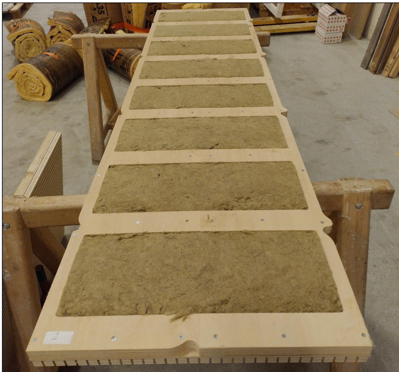
Face arrière d'un panneau 2,4 × 0,6 m avec absorbeur phonique
