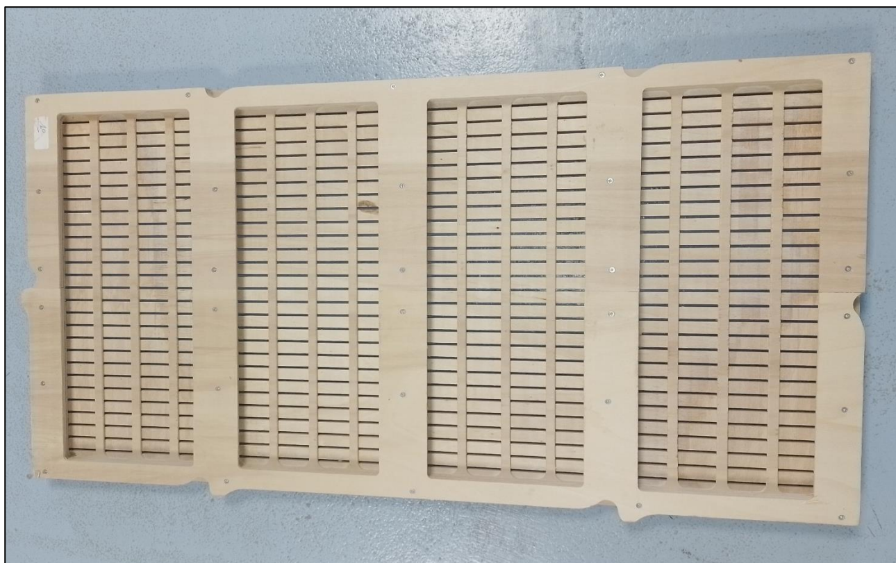
Face arrière d'un panneau 1,2 × 0,6 m sans absorbeur phonique
