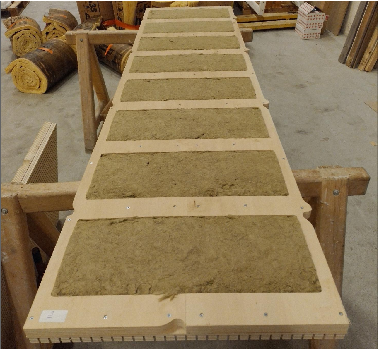
Face arrière d'un panneau 2,4 x 0,6 m avec absorbeur phonique
