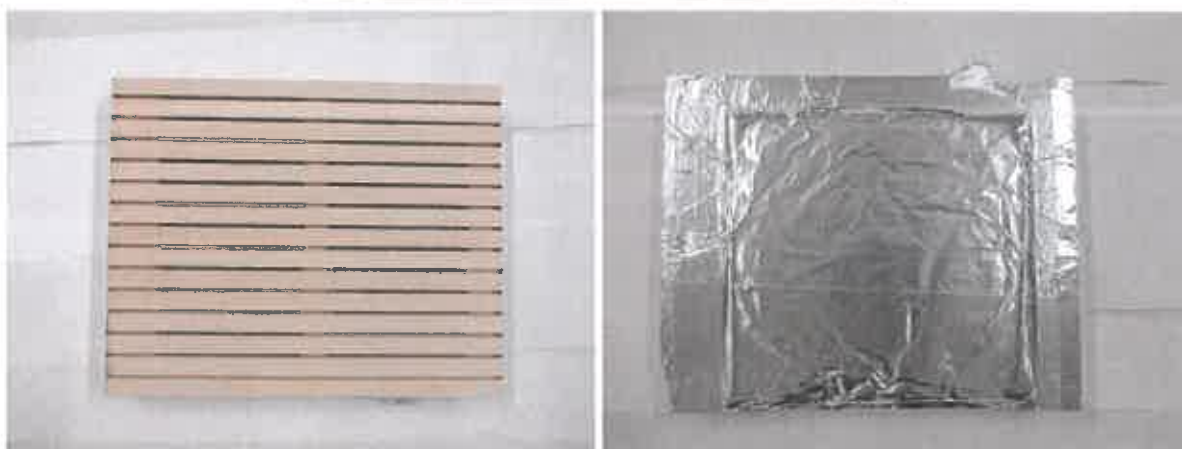
Photo 2 : Eprouvette d'essai après découpe et colmatage
