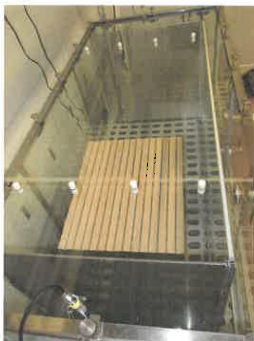
Photo 3 : Epreuve d'essai conditionnée en chambre de test
